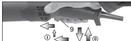
**Mise en marche :** mettre la machine en marche tel que décrit ci-dessous. Pousser à nouveau la gâchette (9) vers l'avant et le relâcher en position antérieure pour bloquer la gâchette (9) (déclenchement).
