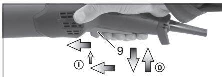
**Conexión:** encienda la máquina tal y como se describe más arriba. Ahora volver a deslizar hacia delante el interruptor (9) y soltarlo en la posición delantera para que el interruptor (9) quede bloqueado (funcionamiento continuo).
